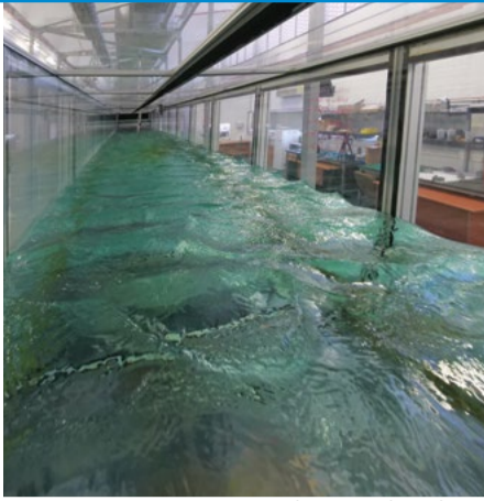
תעלת גלים משולבת במנהרת רוח בה ניתן לחקור תנאי ים פתוח והיווצרות גלים תחת אילוצי רוח. צילום: אדי גרשנגורן
